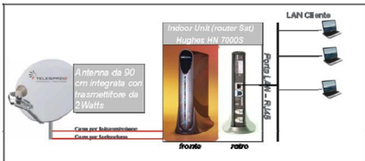
Il terminale GREEN SAT viene abilitato con capacità di DHCP server al fine di gestire l'indirizzamento IP sulla LAN remota;
